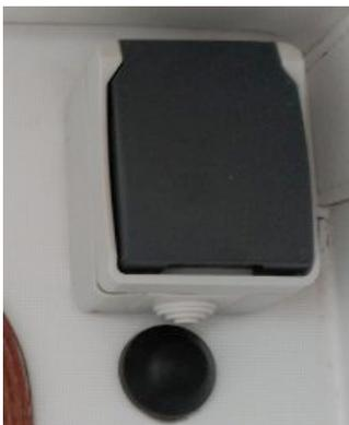
La bomba de achique del baño de proa se activa pulsando el botón negro que hay en la parte superior derecha debajo del enchufe de 220v. EN EL CUADRO ELECTRICO EL BOTON 12 "CONFORT" DEBE ESTAR ACTIVADO PARA QUE FUNCIONE LA BOMBA DE ACHIQUE DEL BAÑO.
