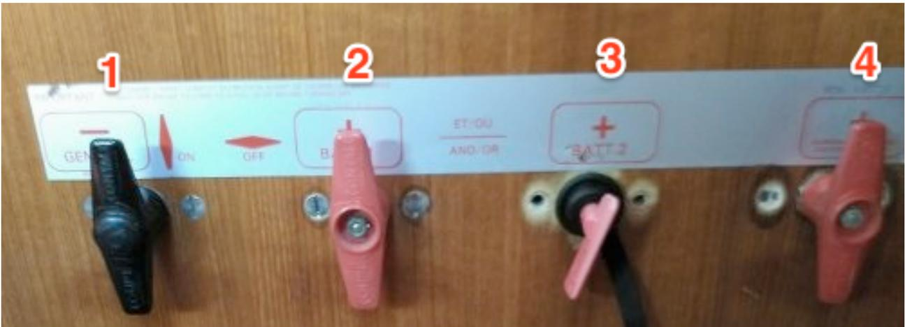
**MACHETES DE BATERIAS, POSICIÓN VERTICAL ENCENDIDO (ON), POSICIÓN HORIZONTAL APAGADO (OFF).**
