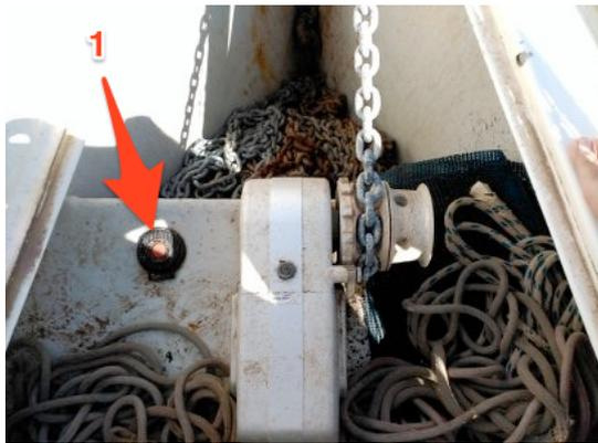
Para soltar el ancla se debe desembragar el molinete (imagen 2). Para ello utilizaremos una palanca que guardamos en el mismo cofre de anclas y empujaremos la palanca hacia nosotros. El ancla caerá por gravedad. No es necesario tener la batería del molinete activada para soltar el ancla.
