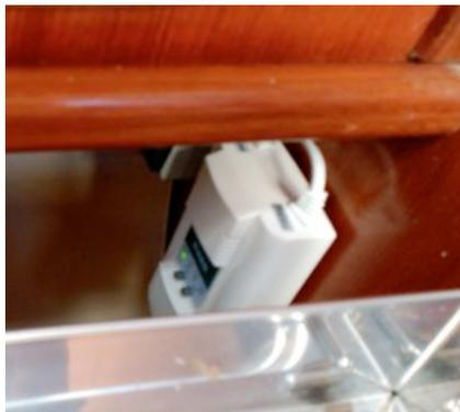
El detector de gas se encuentra justo detrás de la cocina y esta conectado directamente a baterías. Por seguridad continuará encendido aunque anulemos todas la baterías.
